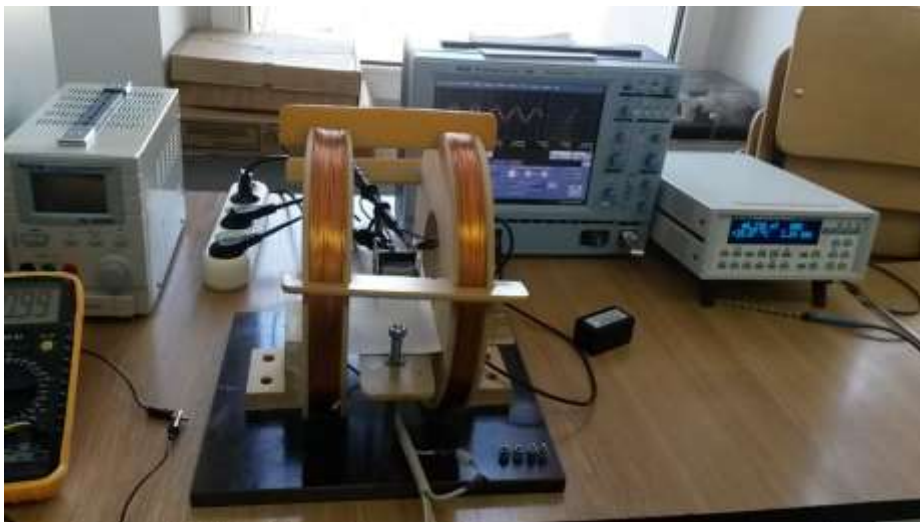
Fig. 9. Schema și aparatele utilizate pentru verificarea bobinelor de câmp cu ajutorul bobinelor Helmholtz.
