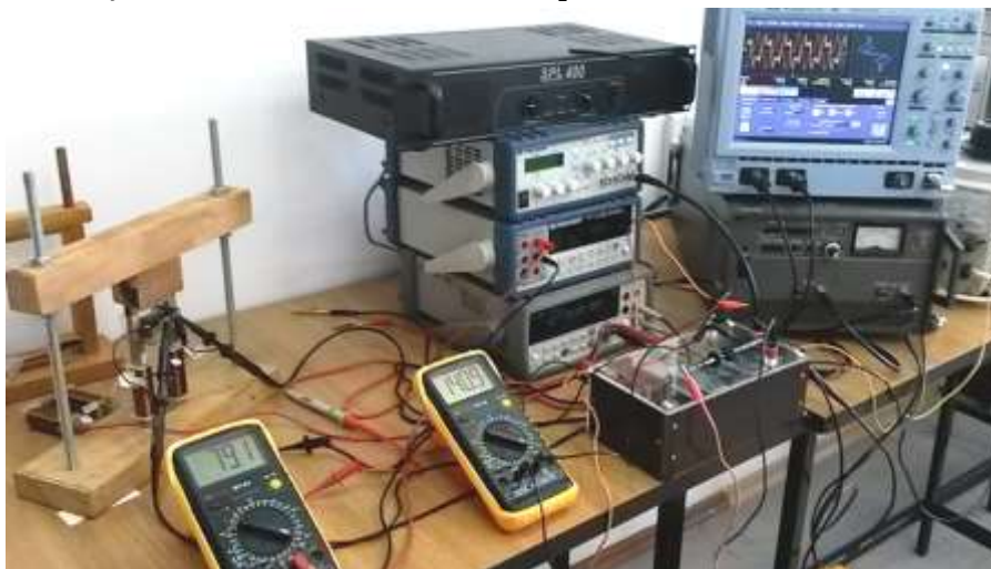
Fig. 1. Lanţul de măsură şi achiziţie incluzând integratorul RC şi bobinele de măsură B , H .
